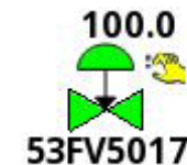
Пиктограмма регулирующего клапана на мнемосхеме
